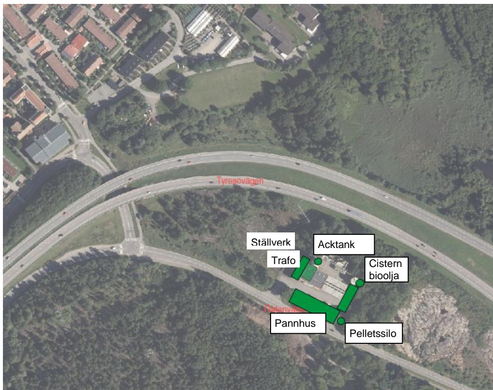
Figur 5. Verksamhet efter förändring (gröna rutor) och en möjlig placering av anläggningens delar. Trafo och ackumulatortank behålls från nuvarande anläggning. Ställverket ingår inte i aktuell verksamhet men kommer också att behållas.
