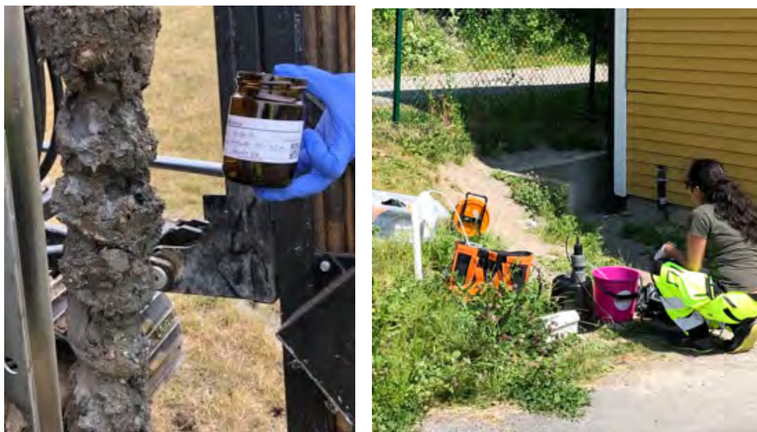
Figur 5. Till vänster: Skruvprovtagning av lera, 30 juni 2020. Laboratorieanalysen visade att jordprovet innehöll den organiska tennföreningen monobutyltenn. Till höger: Pågående lågflödesprovtagning av grundvatten i G20GV01, 25 juni 2020.
