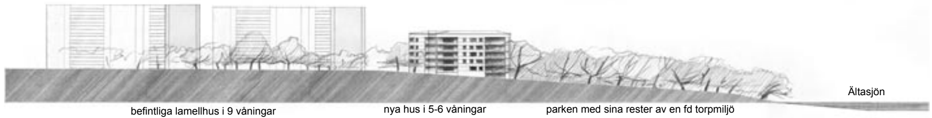
3. Sektion visande övergången mellan befintliga hus, nya hus och Ältasjön; husen trappar sig med markens nivåförändringar ner mot sjön.
