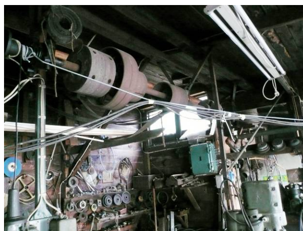
Drivaxeln till banddriften hänger kvar över maskinerna
