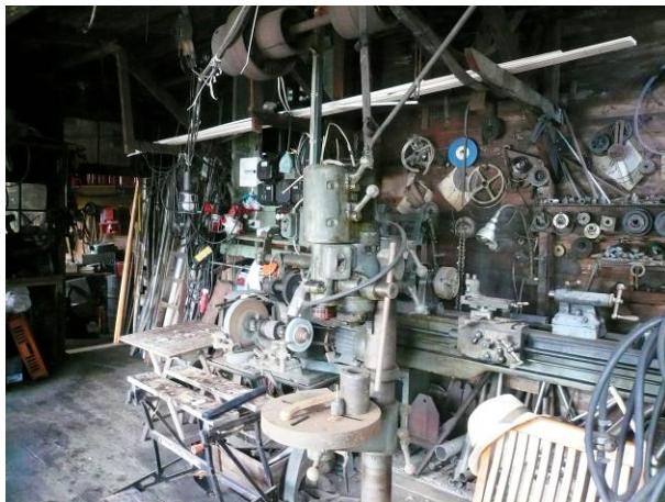
Maskinerna var grupperade på södra sidan av verkstaden. De drevs ursprungligen med banddrift, senare med el-motorer
