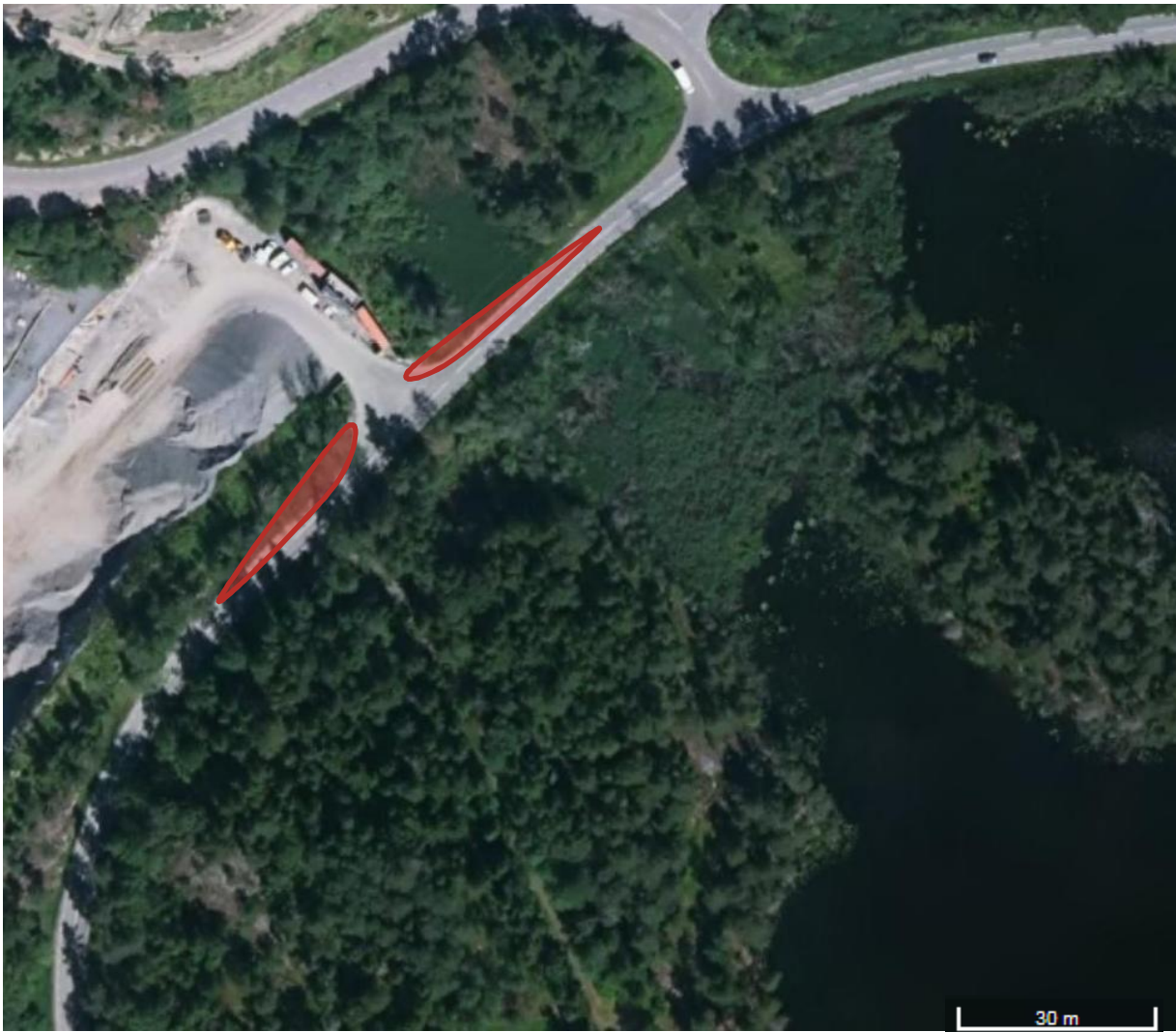
Figur 8-16: Röda områden visar ungefärliga ytor som måste erbjuda fri sikt för att uppnå minsta godtagbara standard för referenshastighet 70 km/h enligt VGU.
