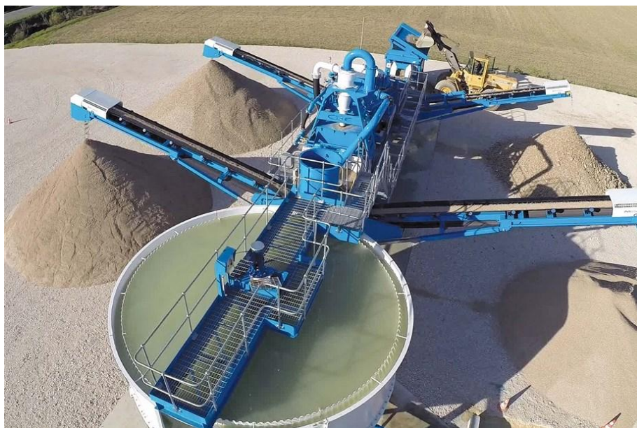
Figur 4-1 Exempel på en våtsikt som lastas med material och olika fraktionerna längs som sorterats ut
